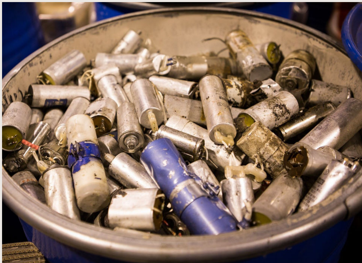
Kondensatorer med PCB, forbudt fra 1980
